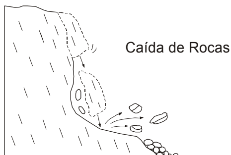
Figura 9: Esquema de caídas tomado de Varnes (1958) en Erskine (1973).
