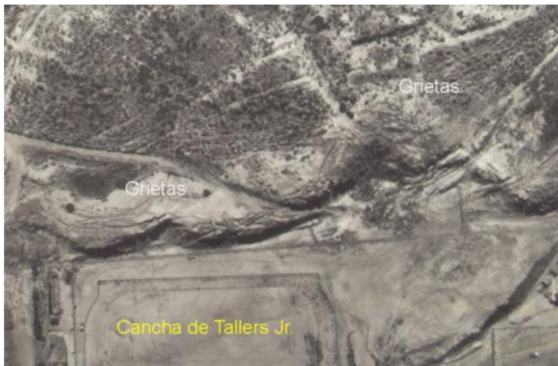
Foto 13: Foto aérea de una zona de la cresta de presión con la formación de grietas sobre la cresta (detalle de Foto 12).
